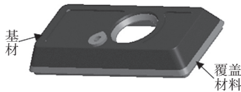
图 3 二次注射成型红外热像仪光圈盖
